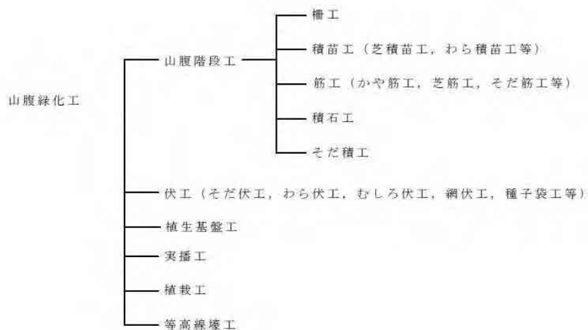
図 2.2.3 山腹基礎工の代表的な工種
