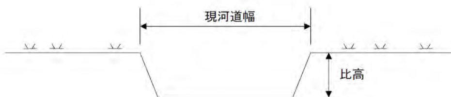
図 1.4.4 掃流区間における生産土砂量の算出
