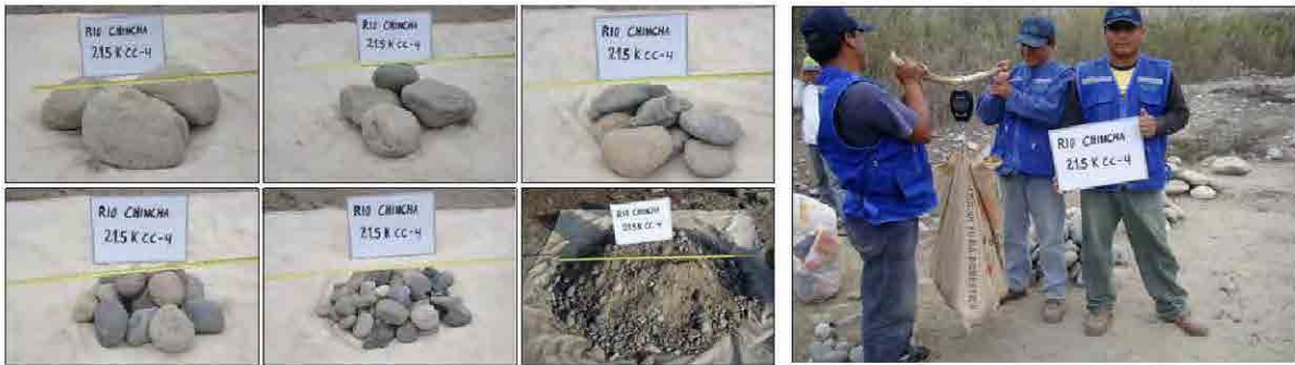
Materiales extraídos de la excavación de la calicata
