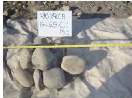
Materiales extraídos de la excavación de la calicata
