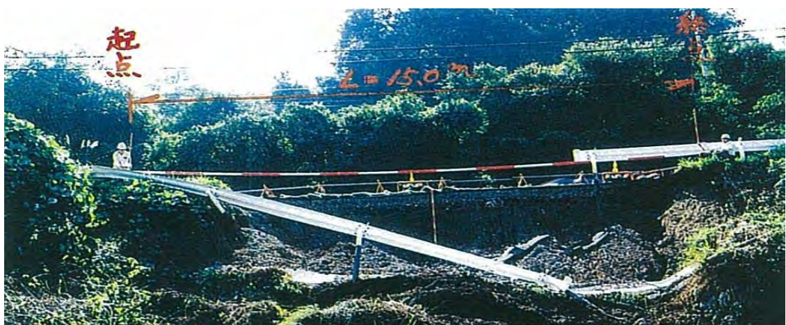
ภาพถ่ายที่ 2.2.2 ตัวอย่างการตรวจวัดแนวเส้นทางที่ได้รับความเสียหายด้วยโพล, Ribbon Rod (ระยะห่าง 1 เมตร)
