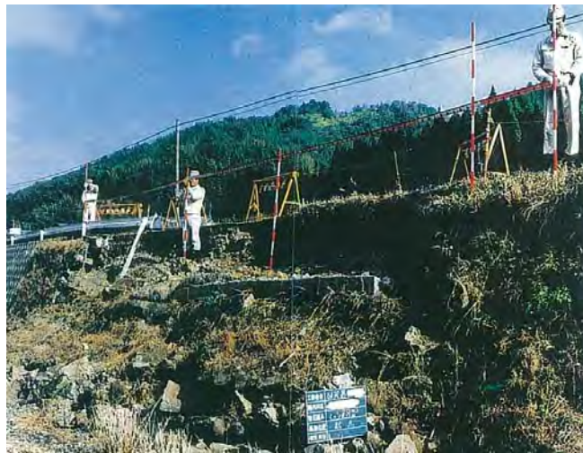
ภาพถ่ายที่ 2.2.4 ตัวอย่างการตรวจวัดแนวเส้นทางที่ได้รับความเสียหายด้วยโพล, Ribbon Rod (ระยะห่าง 1 เมตร)
