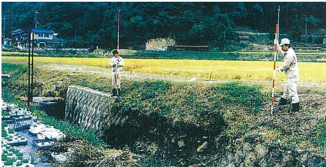
ภาพถ่ายที่ 2.2.5 ตัวอย่างการตรวจวัดแนวเส้นทางที่ได้รับความเสียหายด้วยโพล, เทปวัดระยะ (ผูกด้วยสายฟ้าสีแดง)
