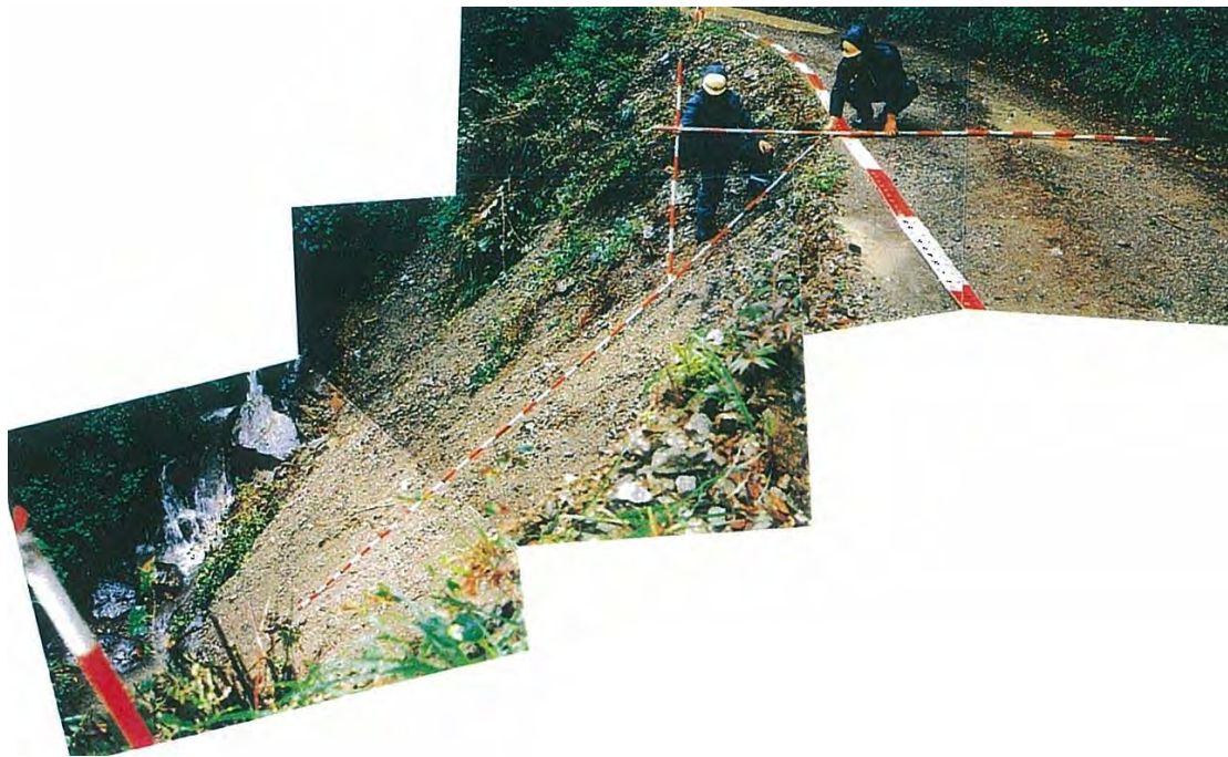
ภาพถ่ายที่ 2.2.13 การตรวจวัดกรณีความลาดชันเกือบเท่ากัน
