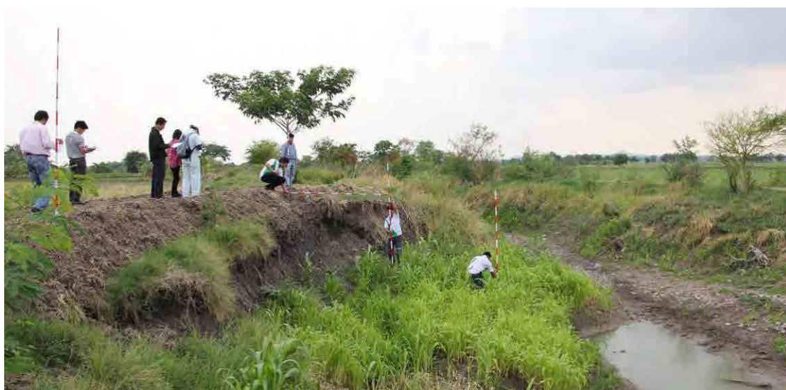
รูปภาพ 8.1-4 สภาพการวัดพื้นที่หน้าตัดจุดแปรผันความเสียหายจากเหตุอุทกภัยด้วยหลักขาวแดง
