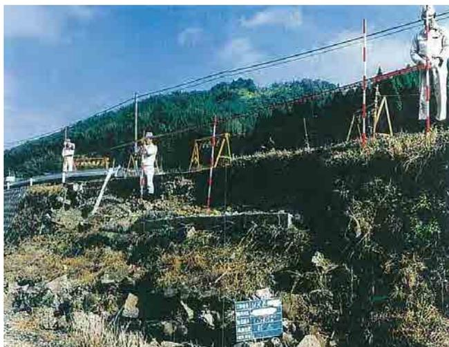
写真 2.2.4 ポール、リボンロッド（1m ピッチ）による被災延長測定 の例
