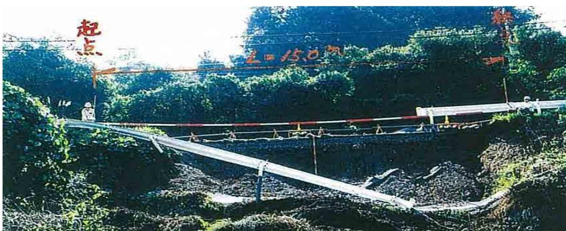
写真 2.2.2 ポール、リボンロッド（1m ピッチ）による被災延長測定の場合
