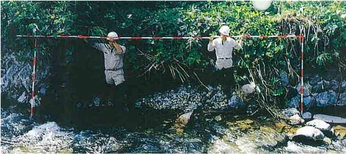
写真 2.2.3 ポールによる被災延長測定の例
