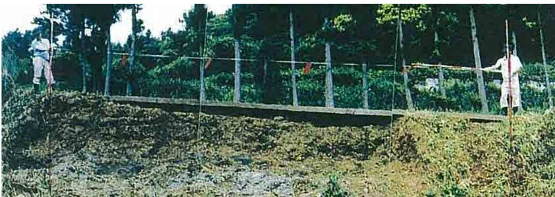
写真 2.2.1 ポール、巻尺（赤布きれ併用）による被災延長測定の場合
