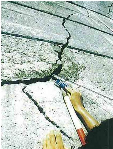
写真 2. 2. 16 コンクリート擁壁のクラック測定
