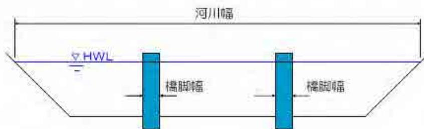
図 8.44-1 河川幅・橋脚幅のイメージ
