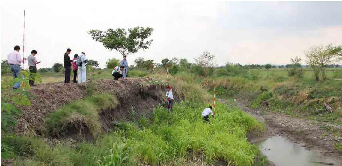
写真 8.1-4 ポールによる洪水被害変化点断面の測定状況
