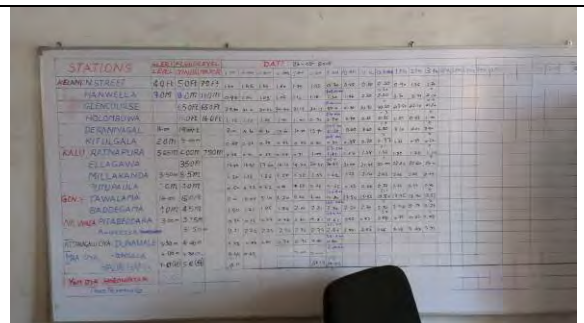
灌漑局の水位観測所から電話・FAX で伝えられる毎時の雨量・水位データを記載するホワイトボード。(灌漑局内)
