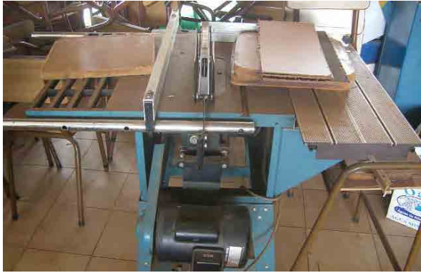
木工機械。スペースが小割にされているため、作業時の安全確保に問題がある。
