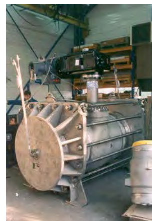
Photo- 21: LNG shutoff valve
