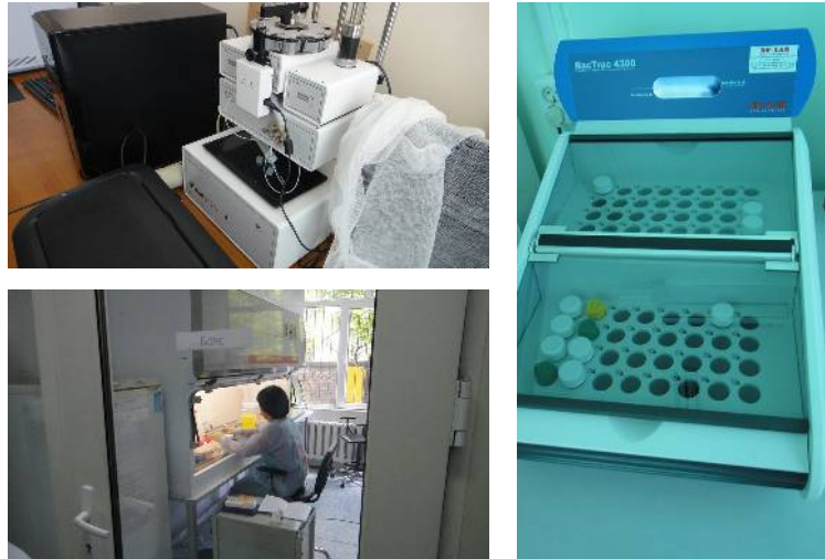
写真 6-1 国立衛生・疫学監督部ラボ(分析機器、衛生ブース、微生物簡易検査機器等)
