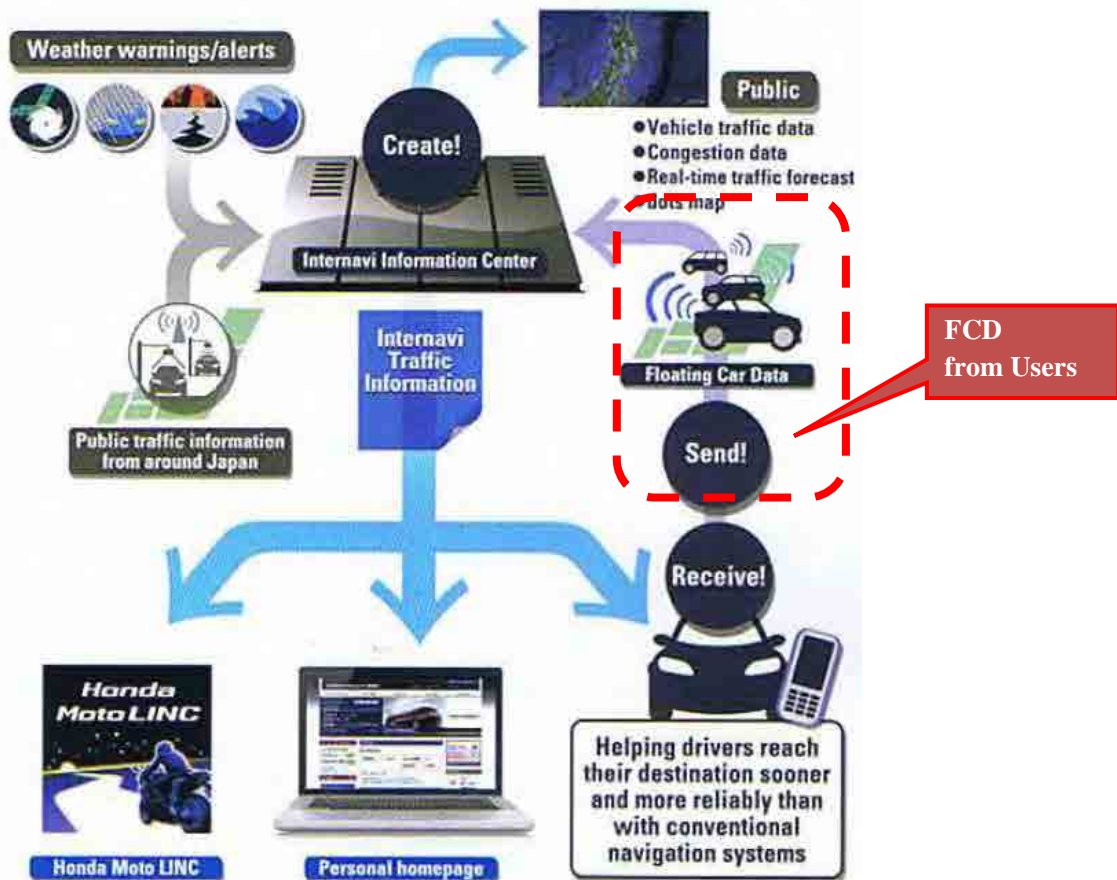
図 9.3-2 車両走行軌跡情報を活用した交通情報の収集・提供の事例
