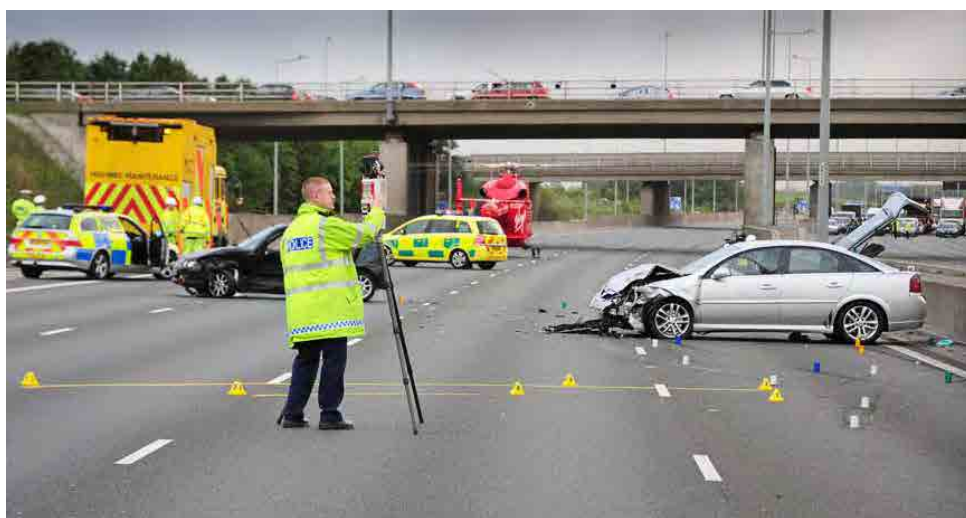
図 9.4-11 三次元レーザースキャナーによる交通事故実況見分
