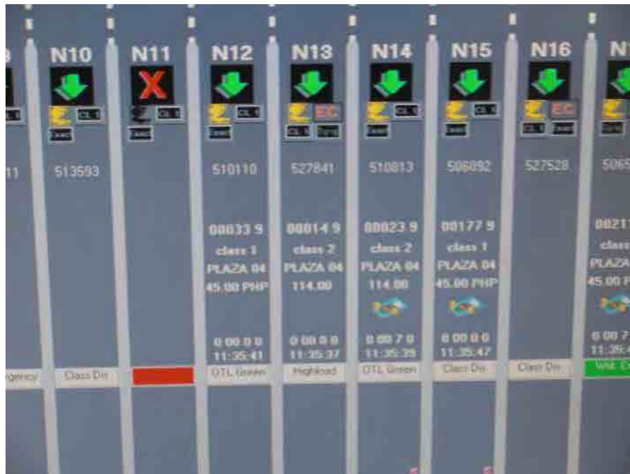
図 6.2-19 料金所ブース監視ディスプレイ
