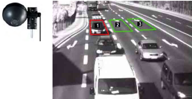
図 6.1-5 CCTV カメラの画像処理による車両検知(TRAFFICAM)
