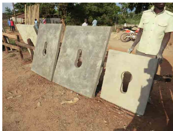
Gulu 市でのコンクリートブロック製作者が並行してコンクリートスラブを販売している。価格と月当り販売数は、小 45,000UGX で 100 個、大 80,000UGX で 80 個程度。町の人が購入することが多いが、村の人でも学校用トイレに購入している。 (2012/12/17 Gulu 県 Gulu 市)
