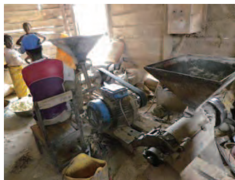
写真 4-6 小型精米機-ヤムスクロ * 籾と糠が混ざって排出される。
