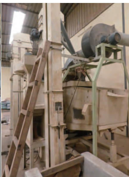
写真 4-8 大型精米機-FENACOVICI * この規模のものは稀
