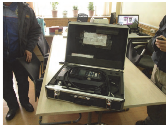
第4火力発電所排ガス測定装置 (2012年12月4日)
