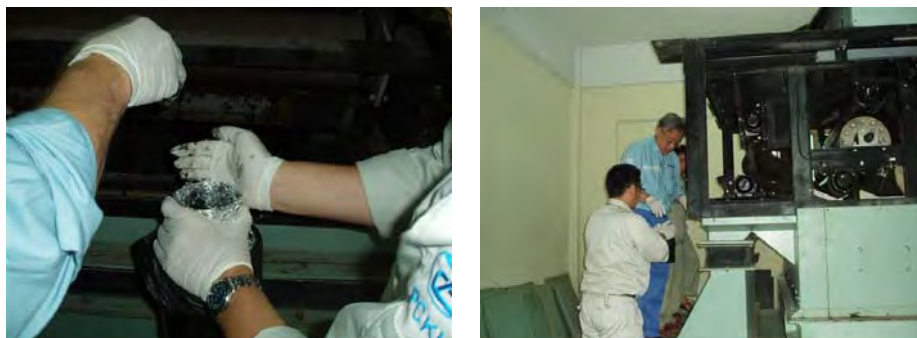
写真-B. 1. 4. 2 脱水汚泥採取状況（キムリエン下水処理場）（出典：JICA 調査団）
