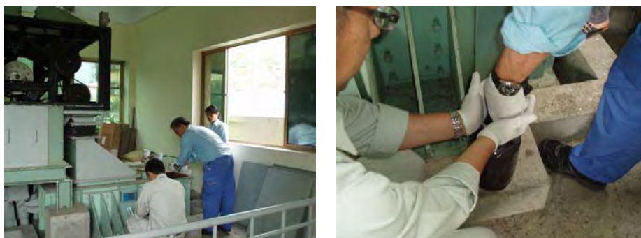
写真-B. 1. 4. 3 脱水汚泥採取状況（チュックバック下水処理場）（出典：JICA 調査団）
