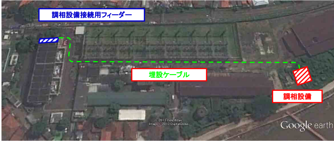
図 5.16 Karet Baru 変電所における調相設備の配置計画(案)
