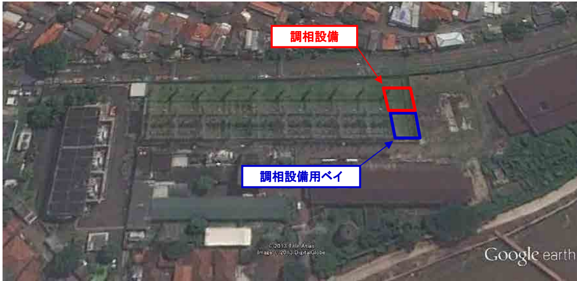
図 5.13 Karet Lama 変電所における調相設備の配置計画
