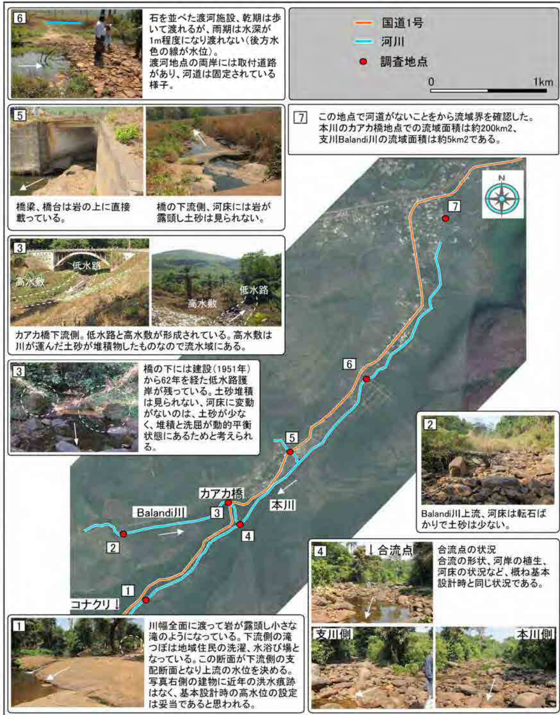
図 2.2-1 カアカ橋周辺の河川状況調査
