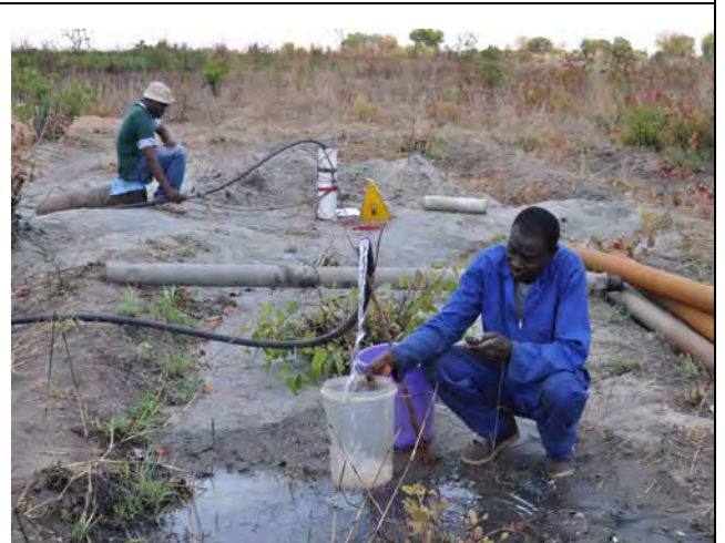
6. 揚水試験 (水量と水位計測) TTC No. 3
