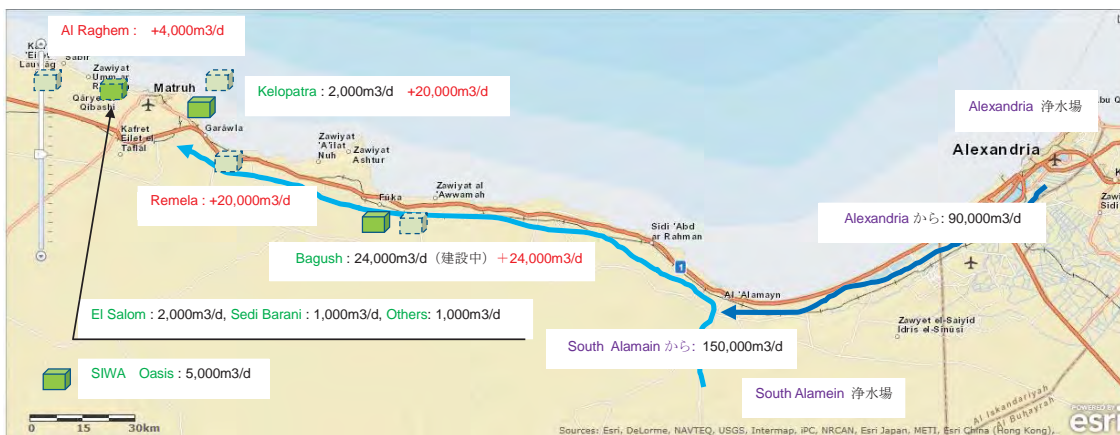
図 3.1-4 「Matrouh 上下水道公社」水供給図 (出所: 同社情報をもとに調査団作成)
