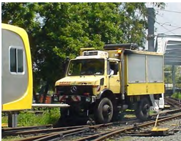
図 5.4.18 軌陸車の例 (マニラ LRT 1 号線)
