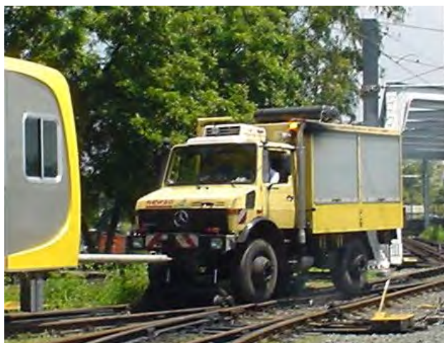
図 5.4.18 軌陸車の例 (マニラ LRT 1 号線)
