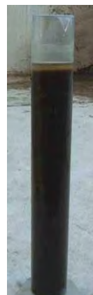
Hình 3.2-3 Kiểm tra điều kiện vận hành của hệ thống xử lý bùn hoạt tính bằng cách lấy mẫu nước thải có chứa bùn hoạt tính
