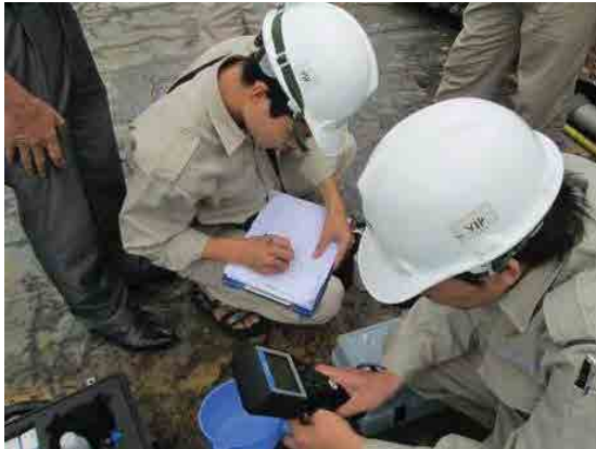
Hình 2.5-6 Kinh nghiệm đo một số chỉ tiêu tại hiện trường bằng máy phân tích chất lượng nước cầm tay
