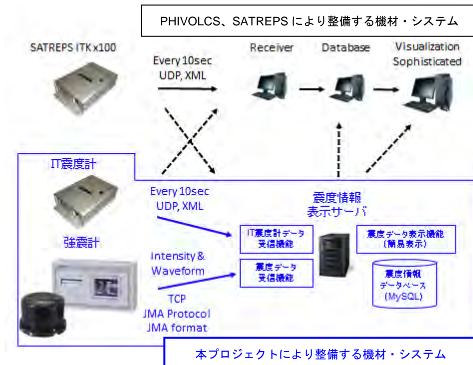
図 3-2 リアルタイム地震観測システム・計測震度ネットワーク概念図
