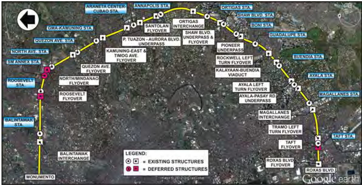
図 9.5-1 MRT-3、LRT-1 の駅舎と高架橋、アンダーパスの位置図
