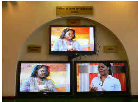
写真-16: 通信情報技術省 (MTTI) の正面入り口に設置された地デジ試験放送用テレビ。上が日本方式、左がアナログ方式、右が欧州方式。
