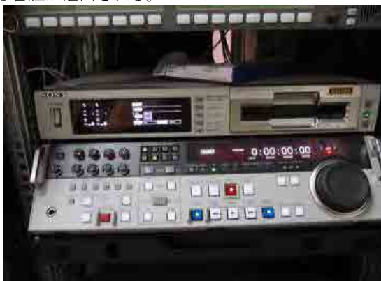
写真-8: MCR、送出機器システム内にある DVCAM 再生機。同機器から本計画番組ソフトが再生される。
