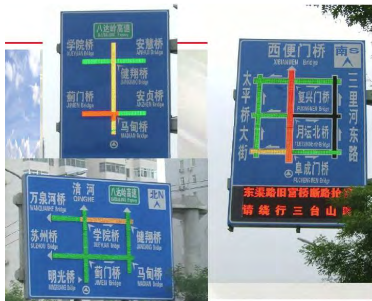
図 2-75 路側に設置された交通情報版の例
