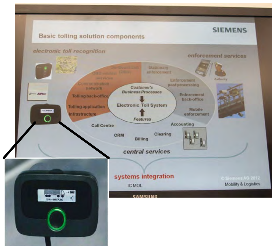
図 2-116 課金システム概略図および車載器 (出典:調査団)
