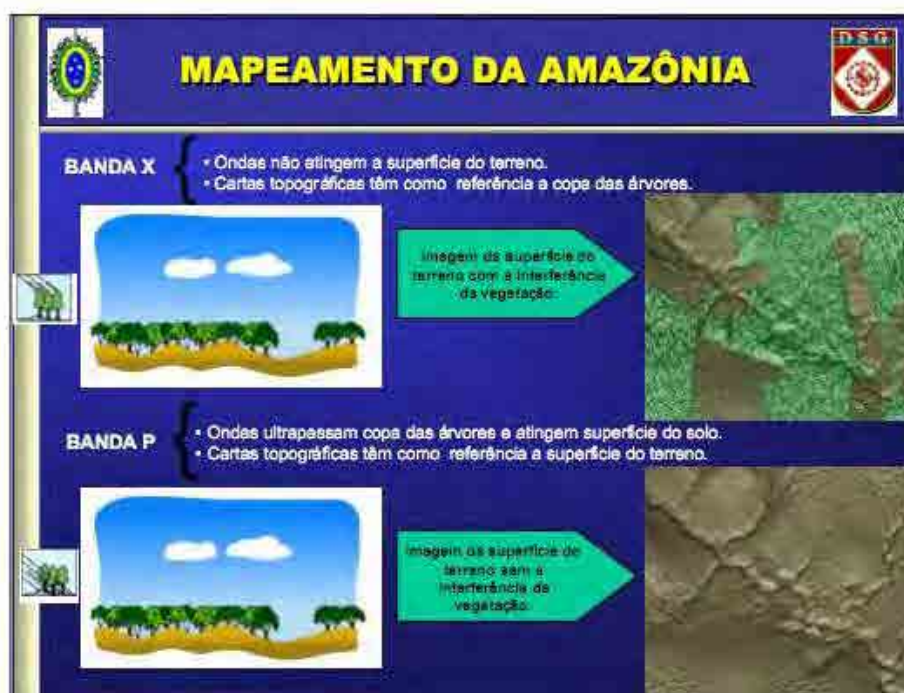
Figura 11: Apresentação do Exército detalhando o mapeamento cartográfico da Amazônia com o uso de sensores de radar nas Bandas X e P, possibilitando a estimativa da biomassa (Disponível em: http://www.cartografia.org.br/boletim/Boletim62.pdf ).
