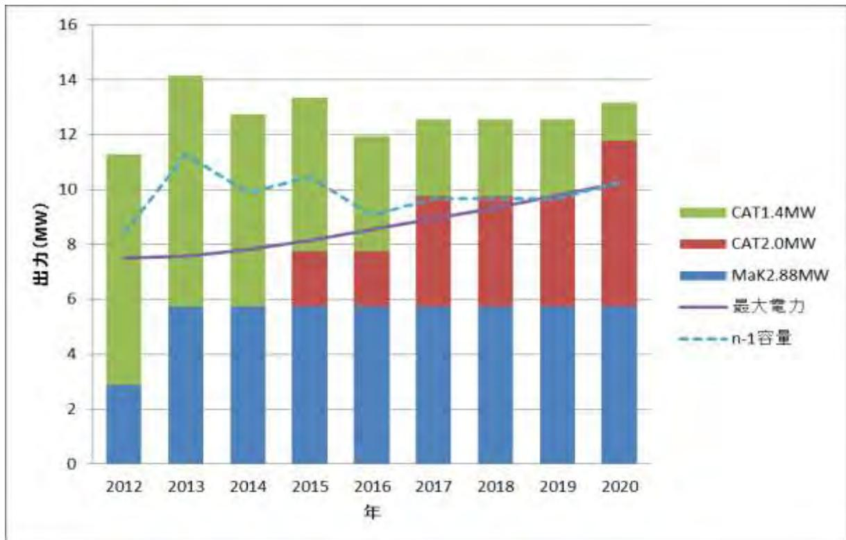
図 3-2-2-1.4 トンガタプ電力系統の電力需給バランス
