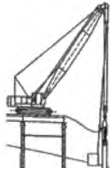
Pose du pieu porteur
