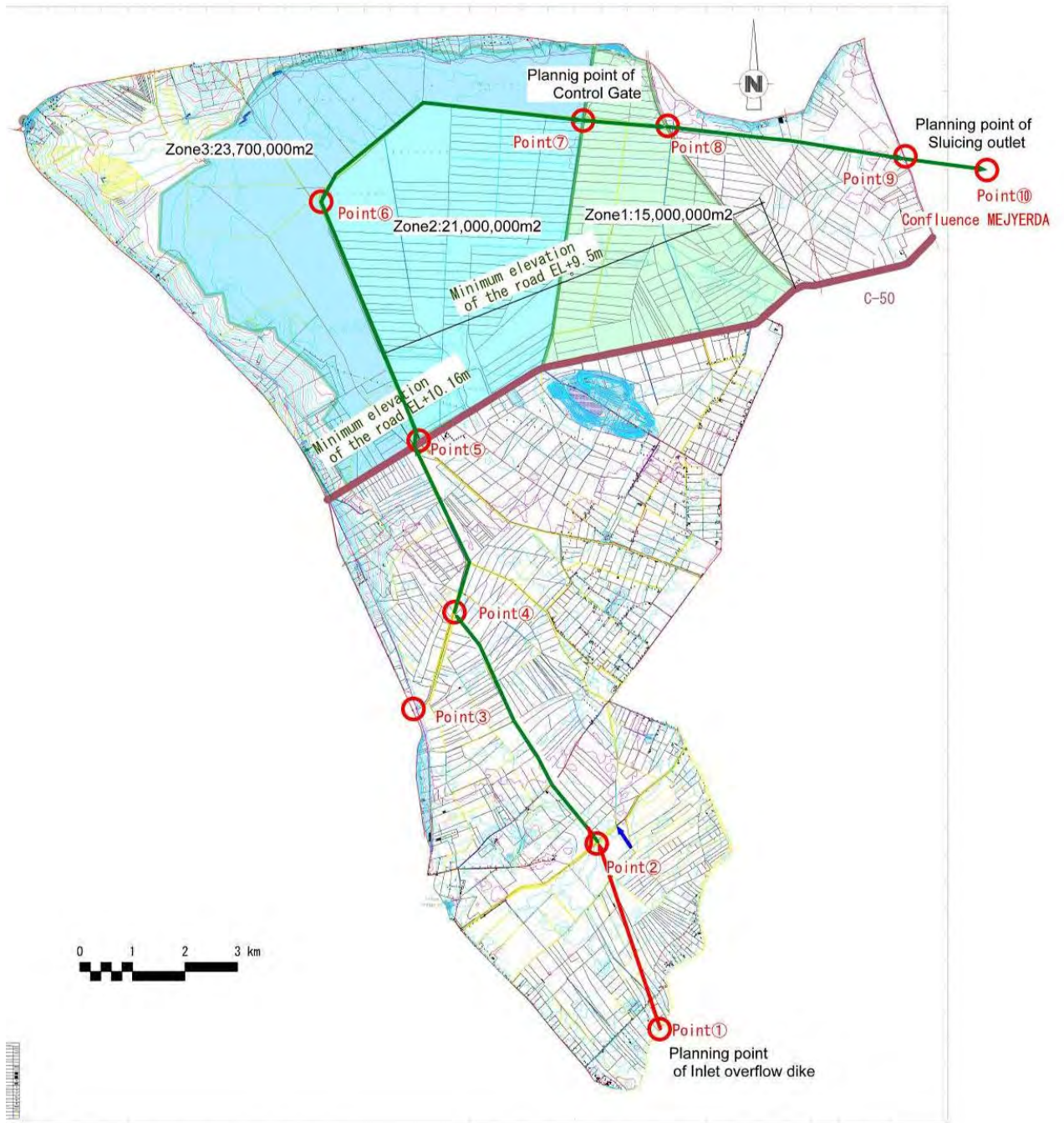
Figure 5.2-1 Plan du projet de bassin de retardement d'El Mabtouh
