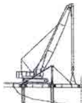
Panneau raccordé à la pile existante et au câble de tirant
