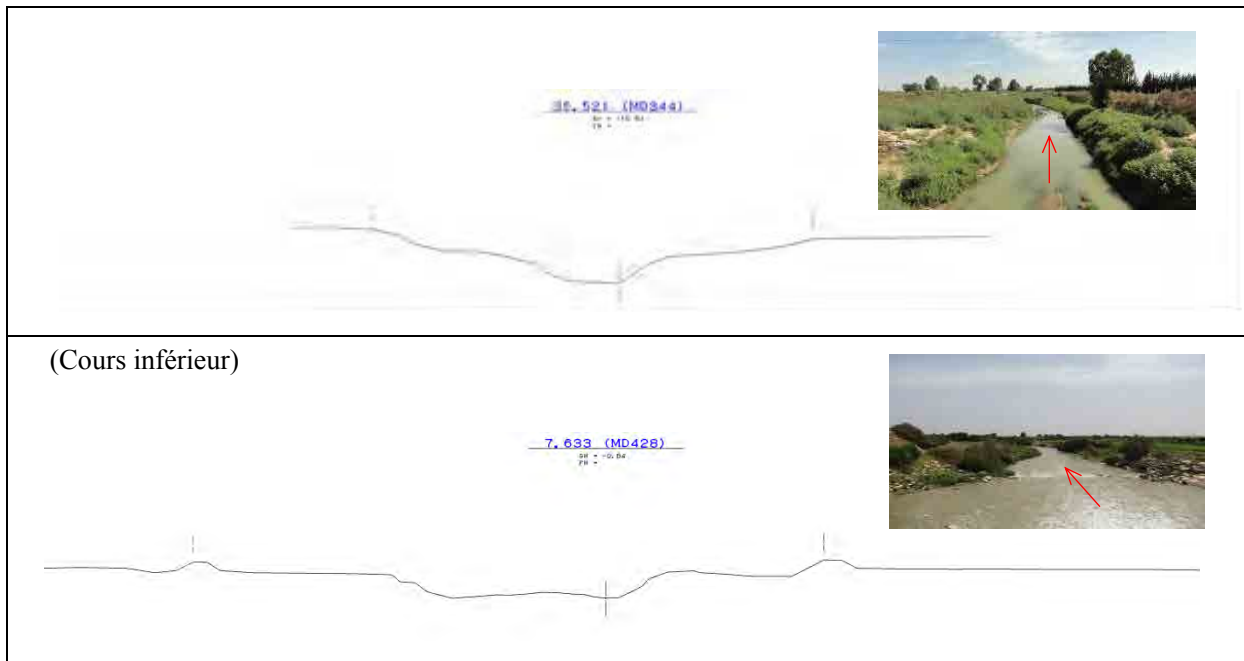
Figure 2-9 Sections caractéristiques du chenal
