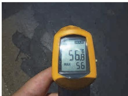
写真 5.1.10 スエズ運河橋路面温度（2012年6月4日：10時撮影）
