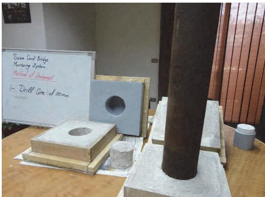
写真 3.4.2 モニタリング孔（直径 110mm）の削孔
