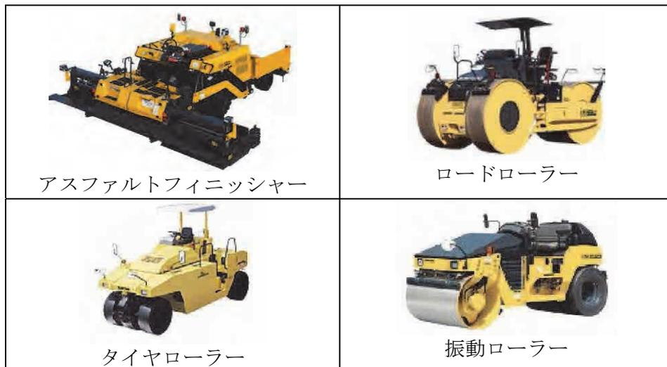
写真 5.2.5 密粒度アスファルト表層工に使用する施工機械
