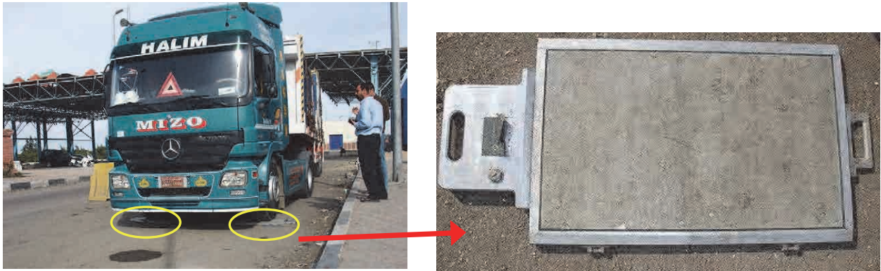
写真 2.4.2 軸重検査状況と計測用踏板
