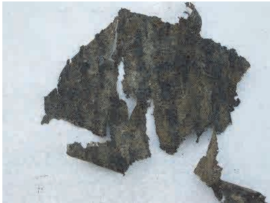
写真 2.2.15 除去した接着層の状況（L1）
