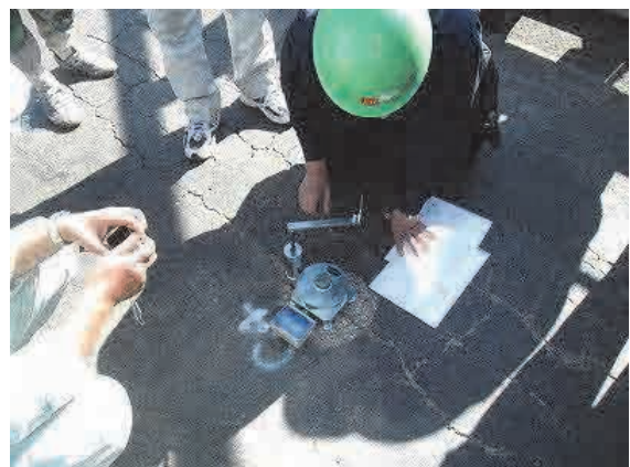
写真 2.2.8 コア抜きと付着力試験
