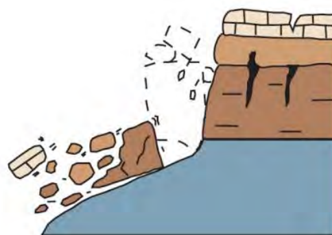
図 2-13 スリランカにおける岩盤崩壊の実例
