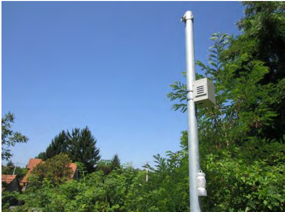
プロジェクトで設置した伸縮計 (コスタンジェック地すべり地)
