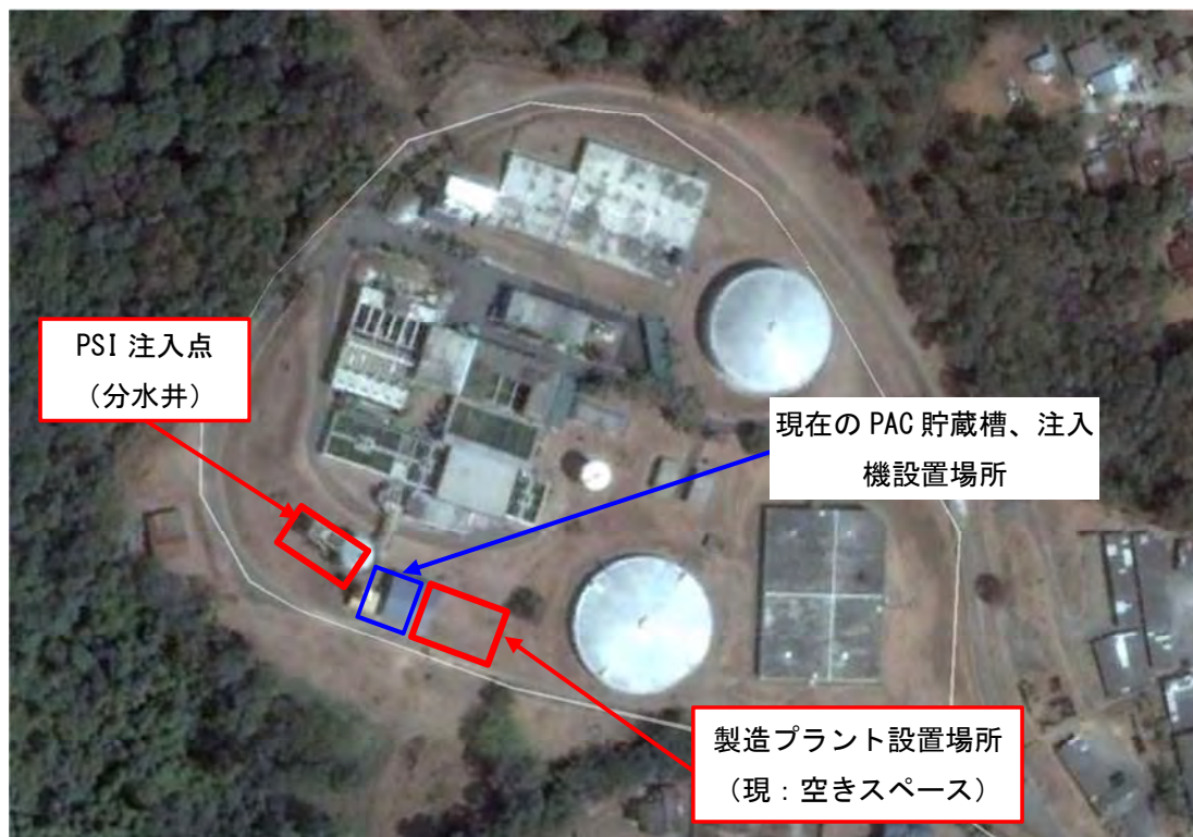
図 4.6 施設設置場所の概要 (Bukit Sebukor 浄水場)
