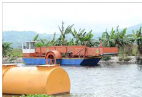
写真-2 導水路上流側の船型除塵機 (水草除去用)
