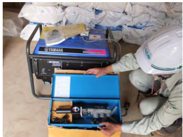
供与機材<プルサット>：手前から SF 融着機、小型発電機、分岐サドル。
