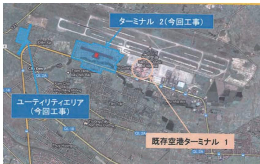
現場は、ノイバイ国際空港の敷地に隣接していることから空港内の規制エリアへの立入制限管理、航空機運航への影響を避ける為の(特に強風時の)厳しいダストコントロール、更にクレーンを使用する場合の高さ制限(45m以下)等に関する適切な管理が求められている。また、ノイバイ国際空港は首都ハノイのゲートウェイ空港であることから、現場の前面を走る空港のアクセスを兼ねた国道は交通量が非常に多く、現場へ出入りする工事関係の車両と一般車両との交通事故(公衆災害)のリスクは極めて高く、適切なトラフィック・コントロールを実施すると同時に、交通事故防止が当現場の重要な課題の一つといえる。
