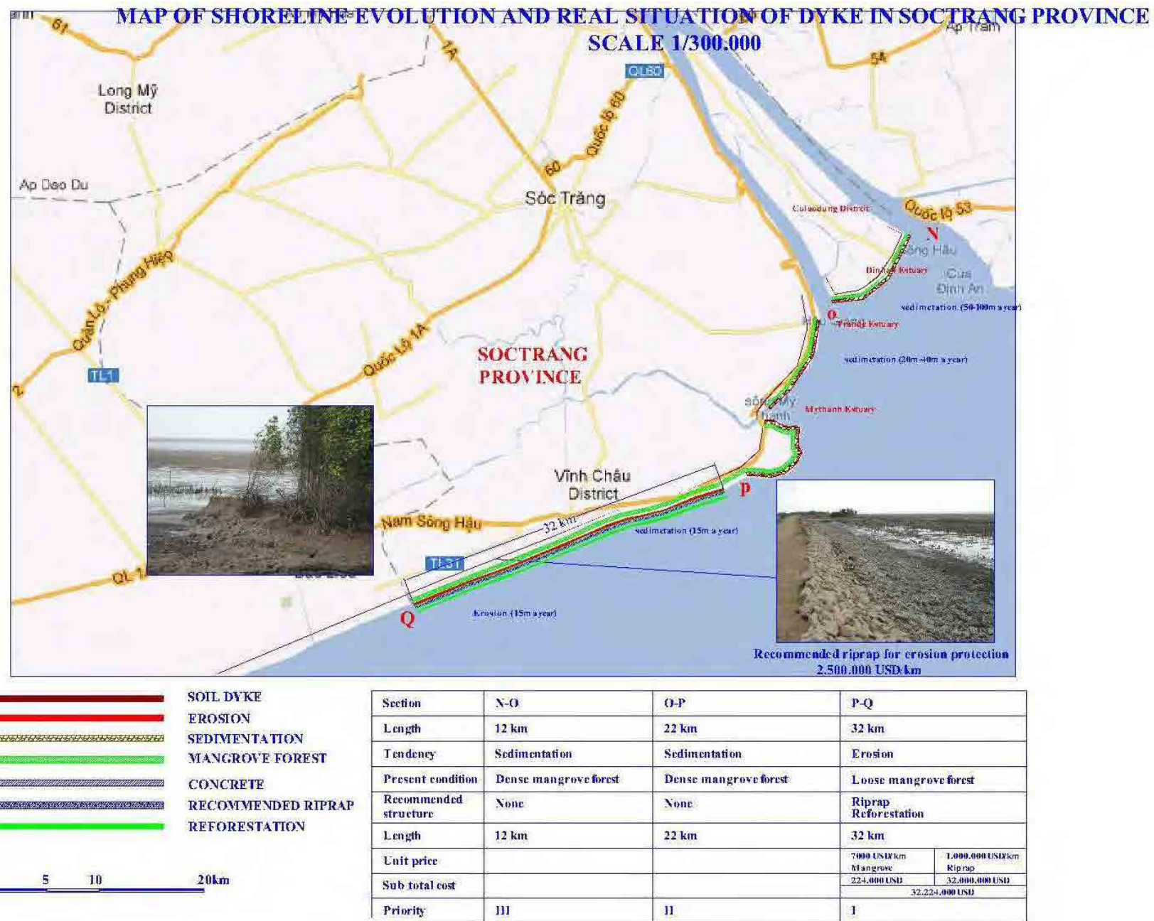
図 6.6.22 沿岸部の形態と保護工 Soc Trang 省(ゾーン 1/ゾーン 2) 出典: ICOE および調査団
