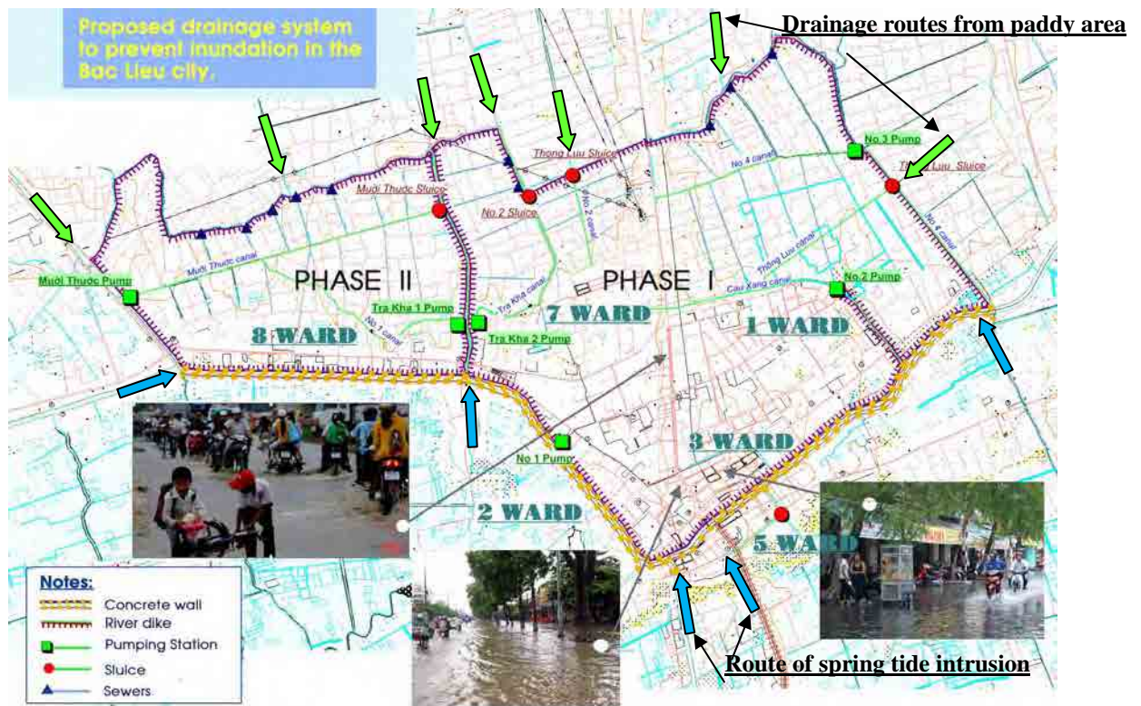
図 6.4.6 Bac Lieu 市街地中心部における海水侵入防止のための一般計画図 (出典: Sub-IHESV 及び調査団)
