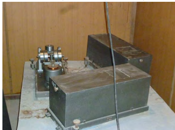
写真12 アシガバット地震観測所に 設置された地震計
