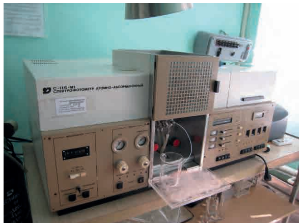
旧ソ連邦時代からの原子吸光分光光度計
