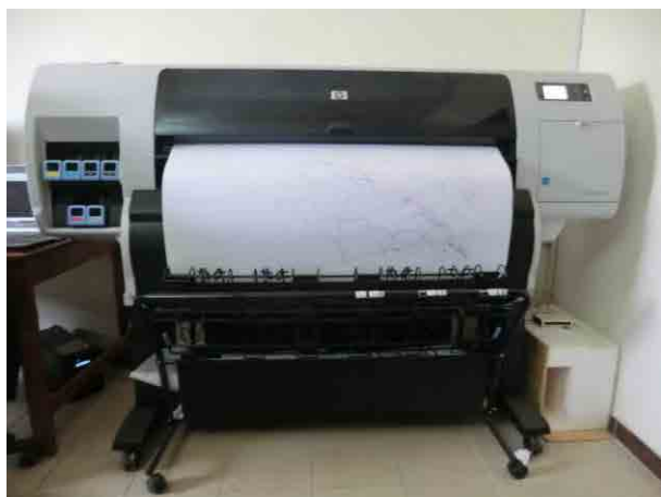
写真 3-7 大判プリンタによる検査図面の出力
