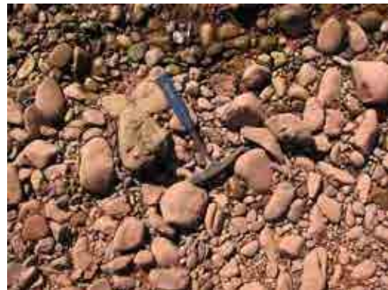
写真 2-6 河床を被う砂礫層 礫混じり砂質土で、若干粘性土を含む
