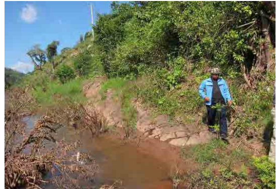
写真 2-6 河床を被う砂礫層 礫混じり砂質土で、若干粘性土を含む
