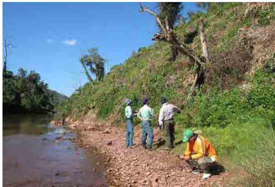
写真 2-5 右岸アバット部の礫混じり粘性土層
