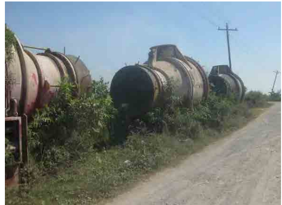
写真-4：約30年前にサイト近くの既設灌漑ゲートで水力開発計画があったが、実施段階で現地条件に合わないことが判明し、調達された水車が放置されている。
