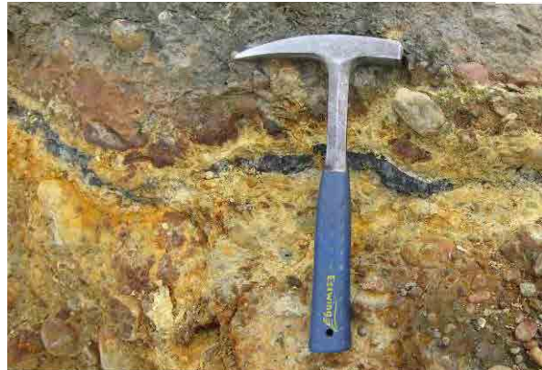
(3) 礫岩は熱水により鉱化変質を被り、硫化鉱物を析出するとともに、粘土化し軟質となっている。
