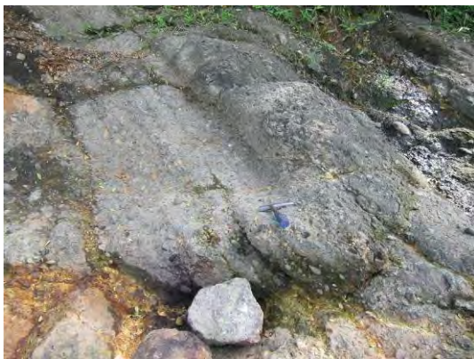
(2) MARIIS ダム下流左岸の礫岩露頭。地層は下流側へ傾斜し、層理面の走向傾斜は、N10E/42SEを示す。
